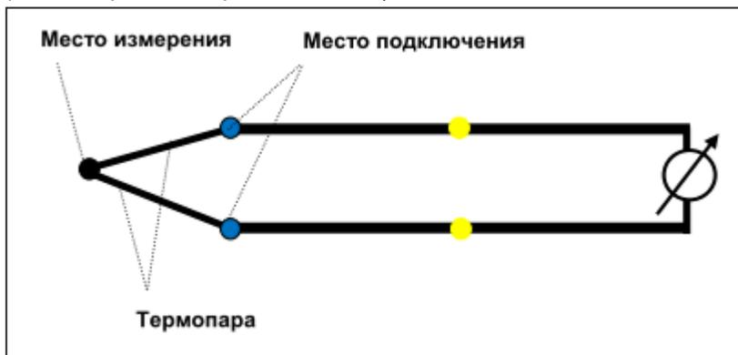
**11.3.2 Схема подключения: Вид взрывозащиты искробезопасная электрическая цепь (применение подходящего оборудования)**
